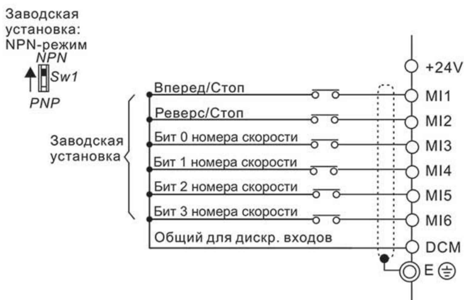
Рисунок 7. Выбор логики управления дискретными входами микропереключателем Sw1. А. NPN-режим без внешнего источника питания
